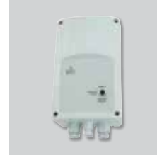
VAPZ Fan hızını basit bir kontağa (mevcut dedektör) veya 0-10 V veya 4-20 mA (C02 probu veya bağlı sensörden) analog girişi ile kontrol eden elektronik monofaze regülatör.
